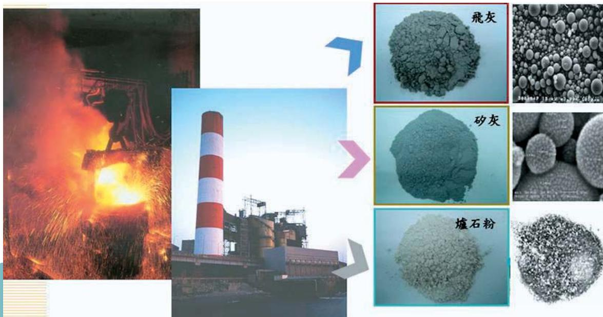
卜作嵐材料（飛灰、矽灰、爐石粉等）原屬工業之廢棄物，現已被廣泛使用。
