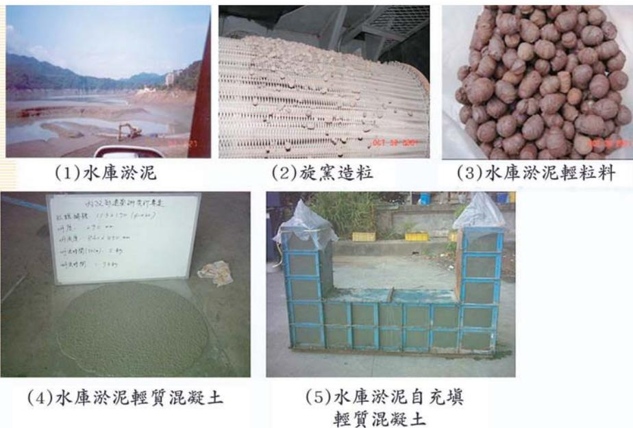
水庫淤泥輕質粒料及製成混凝土。
