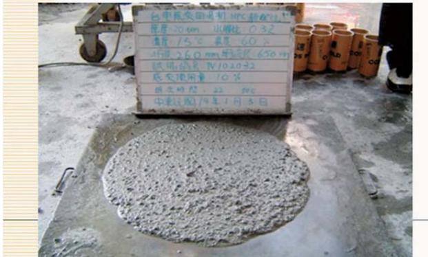
火力發電廠「燃煤底灰」應用於高性能混凝土。
