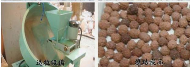
垃圾焚化灰飛灰輕質粒料造粒。
